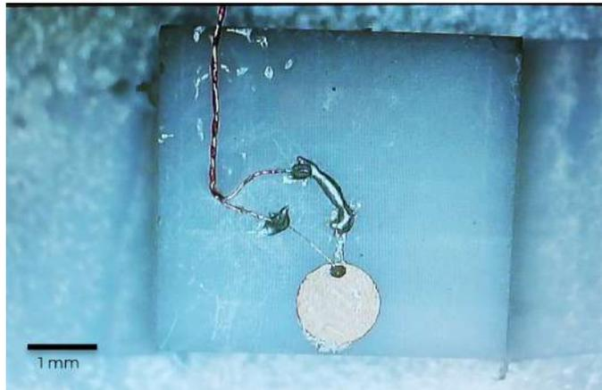
Figura 3.3: Transductor superior instalado en su respectivo soporte.
