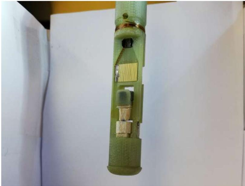
Figura 3.7: Caña para mediciones de RUS fabricada en G-10. En este diseño, los transductores se encuentran embebidos en soportes de balsa, que a su vez se adhieren a la caña con una resina epóxica. El funcionamiento del diseño es idéntico al de la caña en MACOR<sup>®</sup>, donde un soporte pivota sobre un eje mientras el otro es fijo.
