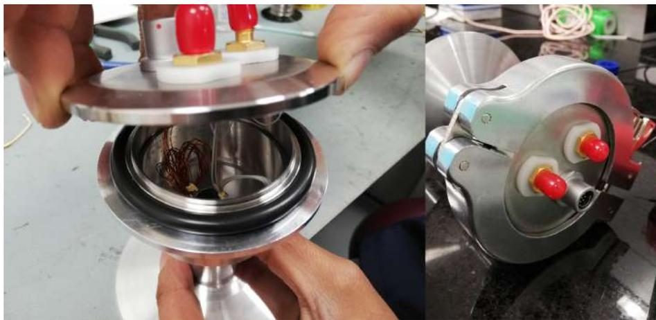
Figura 3.6: Tapa de la caña en MACOR<sup>®</sup> ya cableada. Se observan los dos conectores SMA (con tapa roja), sus respectivos adaptadores (blanco) y el conector Fischer de 8 pines.
