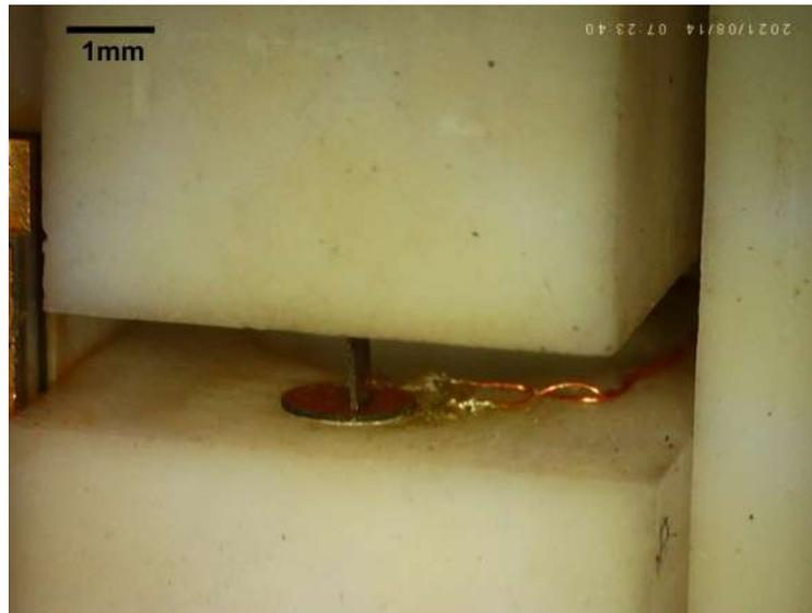
Figura 5.9: Posicionamiento de la muestra pulida de TaTe<sub>4</sub> en la caña en MACOR<sup>®</sup>.
