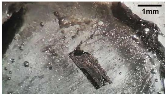
Figura 4.1: Muestra de TaTe<sub>4</sub> embebida en Crystalbond en el proceso de ser pulida.
