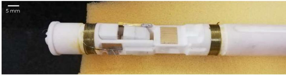
Figura 3.4: Portamuestras con todos los elementos instalados y soldados. Se observan ambos heaters enrollados dentro de sus respectivas ranuras, los soportes de los transductores instalados, y el termómetro pegado cerca del espacio que se forma entre ambos soportes.
