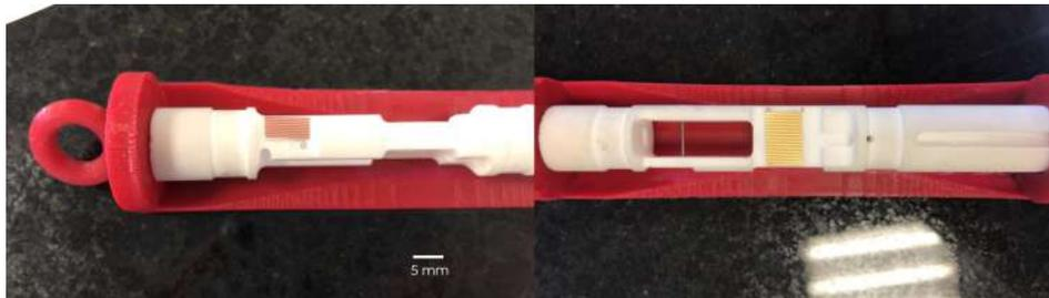
Figura 3.2: Portamuestras en MACOR<sup>®</sup> con eje y caminos de soldadura instalados. En la imagen de la izquierda: vista lateral del portamuestras donde se ve el rodamiento en zafiro al lado del camino de soldadura. En la imagen de la derecha: vista frontal del portamuestras en la que se observa el eje y un camino de soldadura, así como parte del canal que lleva el cableado a la tapa y las ranuras para la instalación de los heaters.
