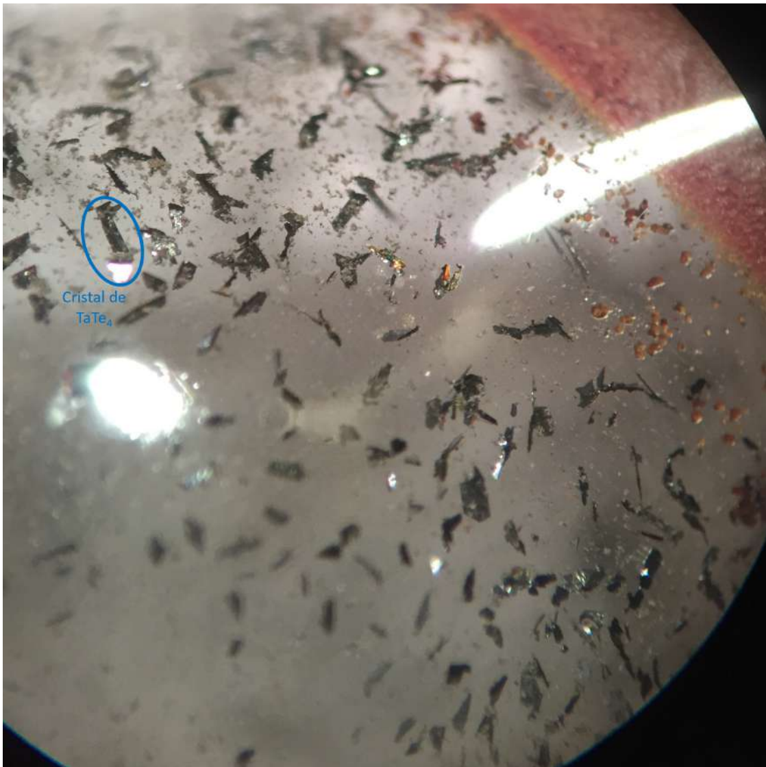
Figura 4.4: Imagen de los cristales del crecimiento por transporte de vapor de \text{TaTe}_4 dopados al 40 % con cobre.
